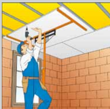
rys. 2 Pokrycie płytami gipsowo-kartonowymi
