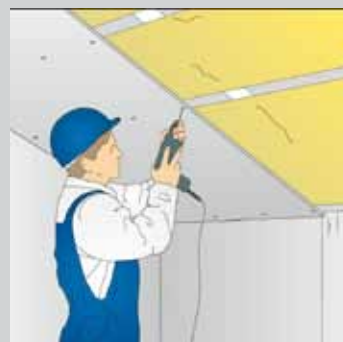
rys. 4 Pokrycie płytami gipsowo-kartonowymi
