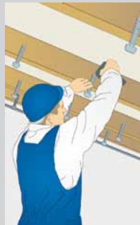
rys. 1a Mocowanie uchwytów do boków krokwi
