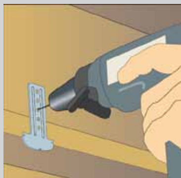
rys. 1b Mocowanie uchwyty za pomocą dwóch wkrętów do drewna
