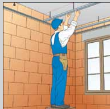
rys. 1 Mocowanie uchwyty ES i profili CD60
