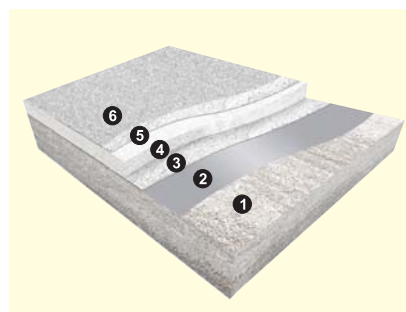
Rys. 1. Typowy układ warstw nawierzchni parkingów lub garaży z zastosowaniem żywic epoksydowych lub poliuretanowych: 1 – podłoże; 2 – gruntownik; 3 – posypka z piasku kwarcowego; 4 – warstwa nośna; 5 – posypka z piasku kwarcowego; 6 – lakierowanie
